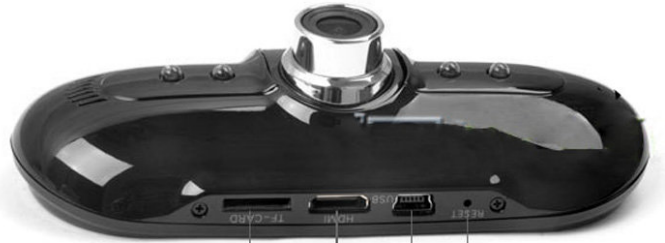
TF卡槽 HDMI 接口 USB接口 复位键
